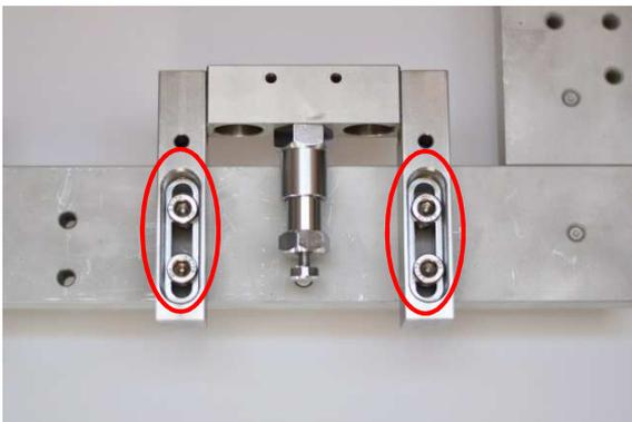
Schrauben Sie die Anschraubhalterung der Fixierleiste mit 2 oder 4 M8x30 Inbusschrauben am Grundrahmen der Erodiermaschine fest.
