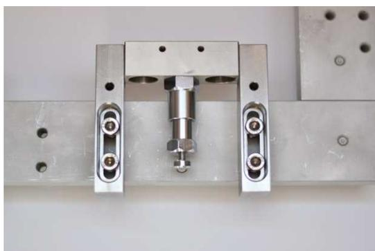
Der Magnet wird einfach in eine der Bohrungen der Fixierleiste gesteckt.
