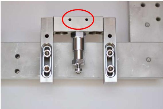
Die Gewinde an der Oberseite zum anschrauben der Spannpratzen.
